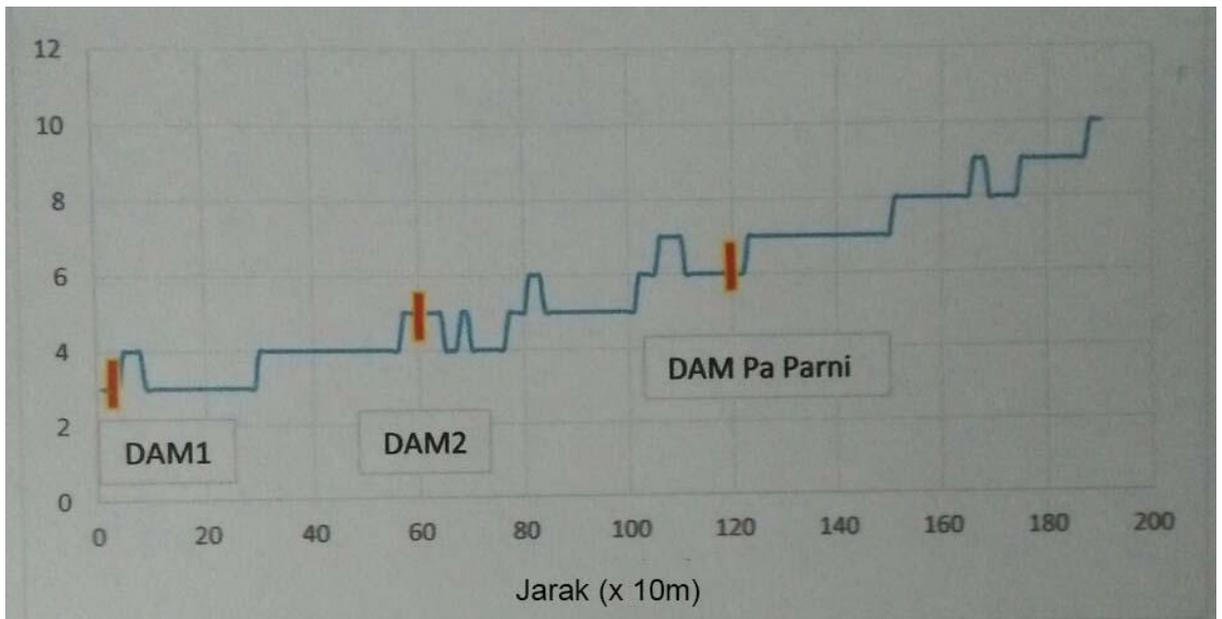
**Gambar 6. Pemetaan Topografi menggunakan GPSMAP 64 sebagai dasar penetapan lokasi dam**
