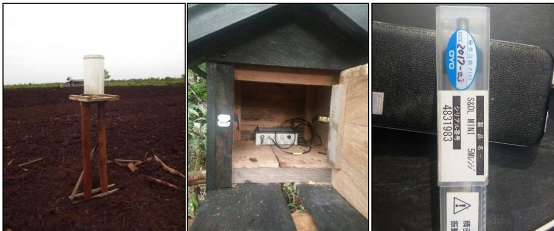
Gambar 18. Peralatan yang terpasang di lokasi Kajian Restorasi Gambut Terintegrasi: Ombrometer, RH dan AWLR
